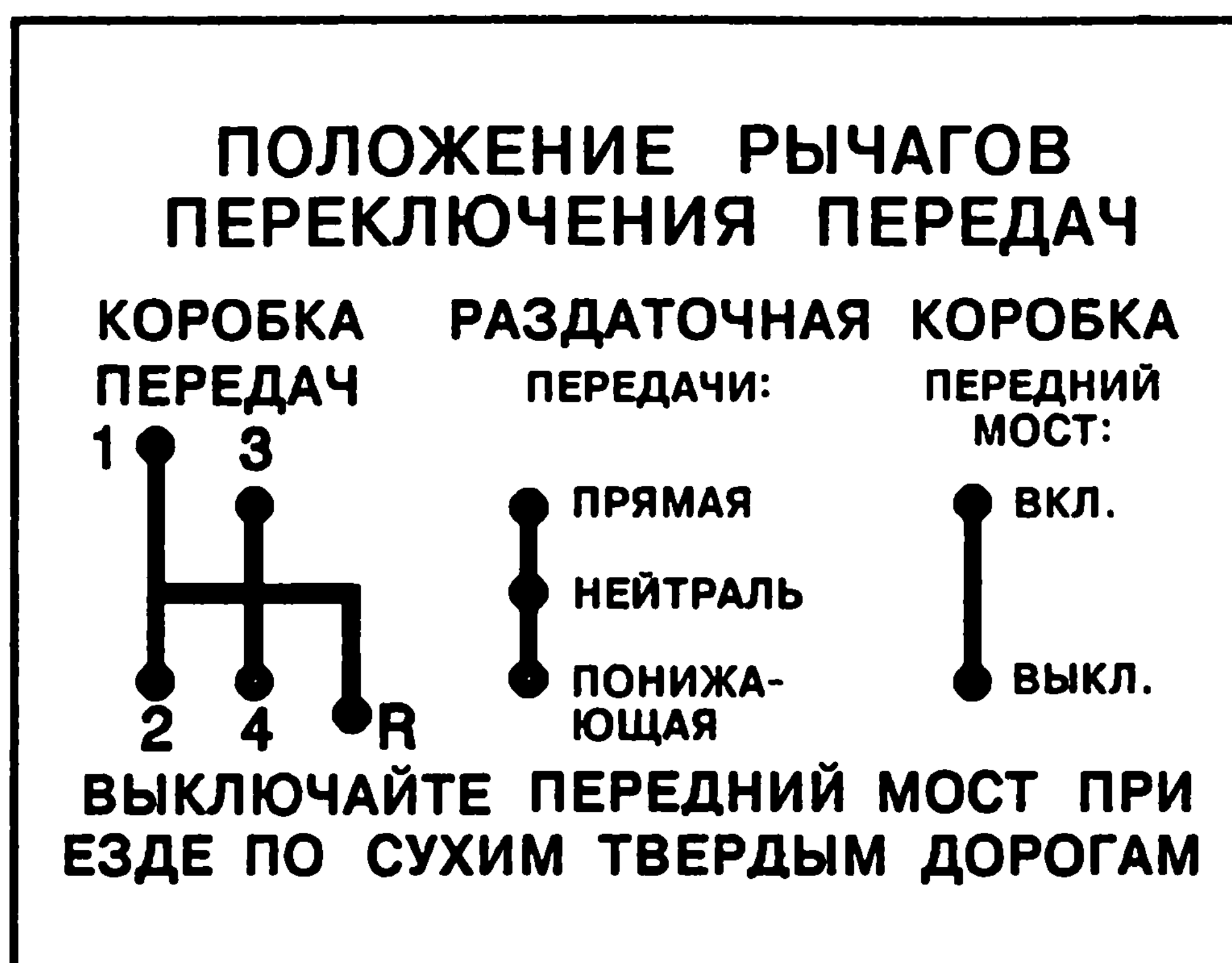
Рис. 12. Схема положений рычага коробки передач и рычагов раздаточной коробки
